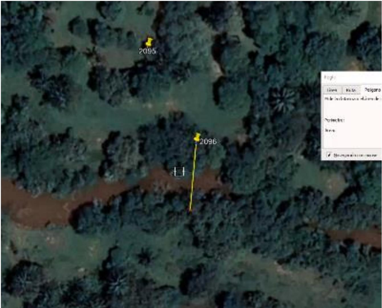
Todo el borde debe tener un poligono de cobertura que incluya todos los componentes del proyecto. Dentro de la red de distribución cada 500m debe ir un punto geodesico que sirva de control y posible replanteo. Se pide equipos geodesico de doble frecuencia. Se puede utilizar Magna Sirgas que están en Ibagué y una posiblemente en Purificación.
