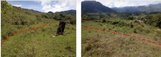
Plano de falla localizado al oriente de los tanques de almacenamiento.
