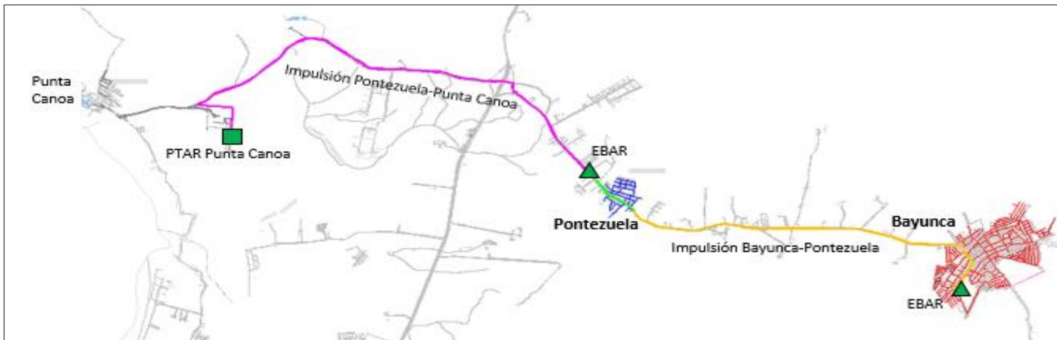
Propone redes secundarias en cada uno de los corregimientos, las cuales drenarán hacia un colector principal. Cada corregimiento evacuará a gravedad hacia su propia estación de bombeo y posteriormente la estación de Bayunca impulsará las aguas servidas hasta un colector de Pontezuela. La estación de bombeo de Pontezuela impulsará las aguas residuales hasta la planta de tratamiento de Punta Canoa.
