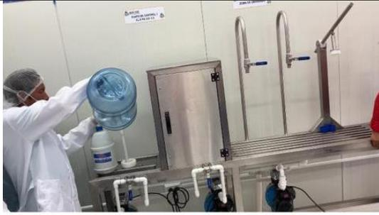
3. Posteriormente se coloca sobre una mini despensa para lavado interno y externo
