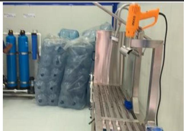
En la imagen se aprecia una máquina para lavado de llenado y sellado de botellones. Esta instalación se realizó con el objetivo de manipular lo menos posible tanto los botellones como el agua que se entregará a la comunidad para su consumo. Al fondo se aprecia las botellones y los cilindros de cloro.
