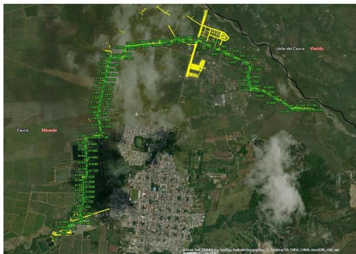
*Imagen. Trazado del interceptor proyectado.*
