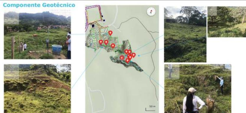
Se levantaron puntos de las zonas geomorfológicas inestables, y se resalta la zona donde está ubicado el UASB, donde puede presentar un nivel de riesgo importante, por lo cual se recomienda realizar una trinchera con el fin de evaluar como afloran los suelos, en esa zona, en campo se realizó exploración superficial para verificar.
