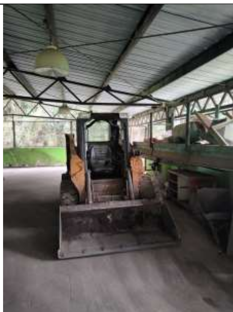
Fotografía 7. Bobcat para volteo de pilas
