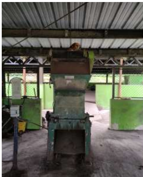
Fotografía 8. Molino para soltar el material madurado
