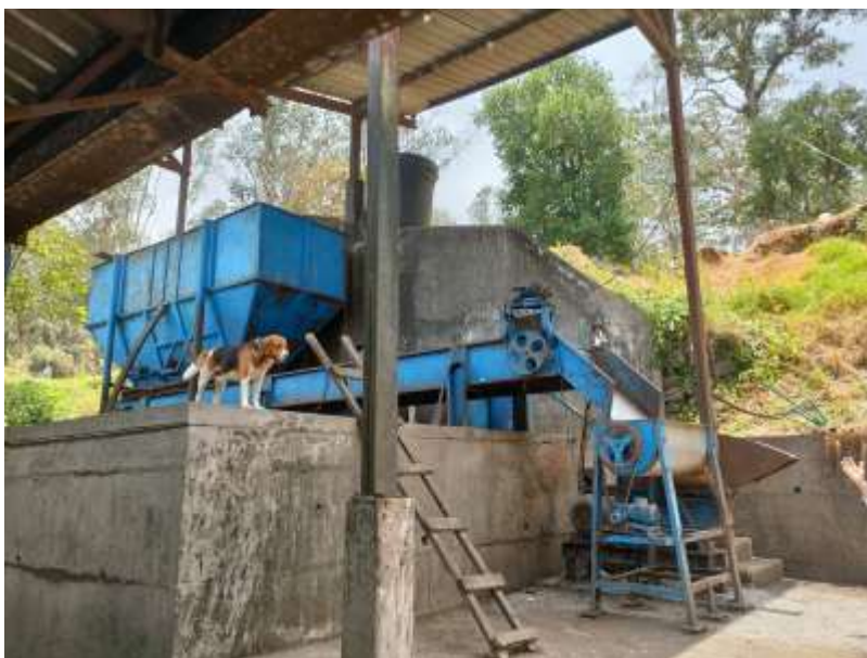
Fotografía 4. Tolva de alimentación, banda transportadora y trituradora
