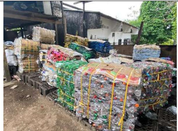
**Fotografía 8.** Material reciclable plástico compactado y acopiado listo para ser cargado y transportado hacia el aeropuerto. Fuente MVCT 19-10-2023
