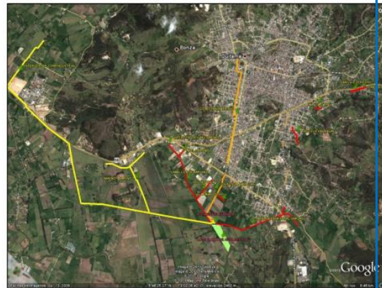
Red de colectores e interceptores dentro del sistema interno del alcantarillado
