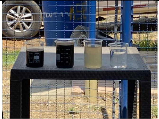
**Fotografía 9.** Resultado de los diferentes procesos de tratamiento de lixiviado. Fuente MVCT 18-03-2024
