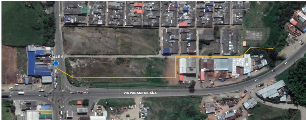
**Posible diseño de cambio del punto de descarga del alcantarillado pluvial.**
