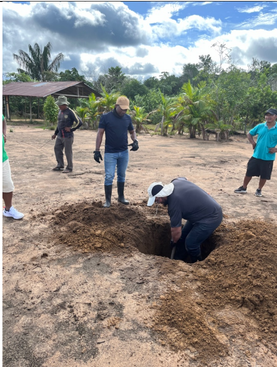
Excavaciones para muestras de suelo y pruebas de resistencia - Chorroboacán
