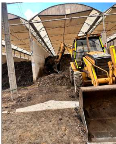
Imagen 3. Maquinaria para acomodación de residuos en Biodomos
