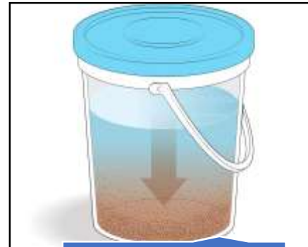
Balde de asentamiento
