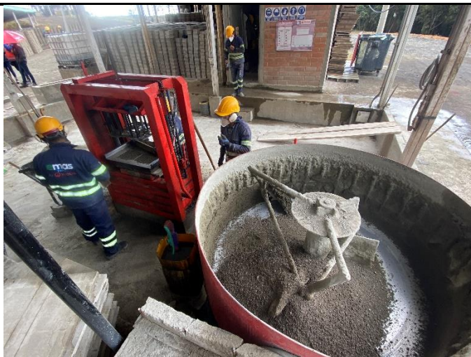
Fotografía 8. Sistema de mezcla y prensa para la elaboración de ladrillos producto de la selección, triturado y mezclado de RCD en el parque tecnológico y ambiental ANTANAS-Pasto, Nariño. Fuente MVCT 09-09-2024
