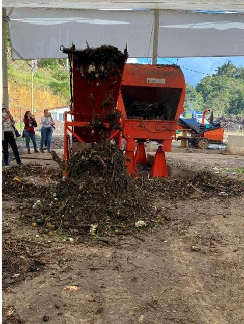
**Fotografía 19.** Vista planta de compostaje del municipio de Santuario-Antioquia, trituradora material vegetal. Fuente MVCT 01-10-2024
