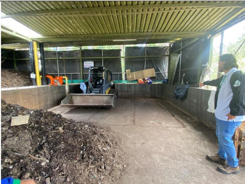
**Fotografía 15.** Visita planta de compostaje del municipio de Santuario-Antioquia, motor para inyección de aire y minicargador para volteo en zona de maduración. Fuente MVCT 01-10-2024
