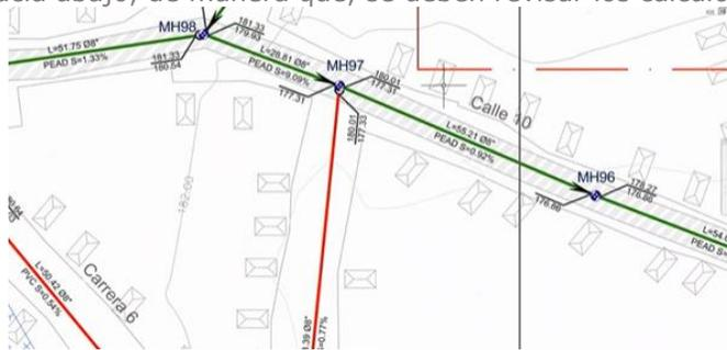
6. Para este caso, el MH 97, si no se puede mover la Línea Verde, no puede conectar el rojo al pozo de inspección, sino que al pie del pozo de inspección tiene que poner un tubo que llama tubo de inspección y limpieza, que sirve para meter una sonda cuando haya que hacerle mantenimiento a ese tramo.
