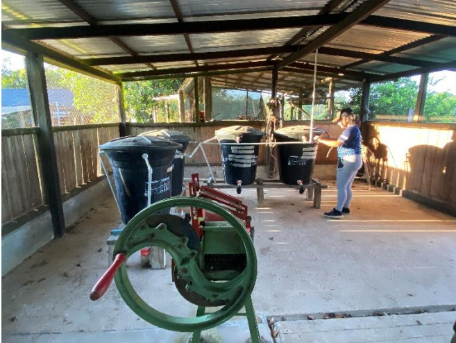
Fotografía 11. Sistema de tratamiento de residuo sólidos orgánicos para generación de fertilizante líquido en la granja experimental del colegio Maquilam. Fuente MVCT 07-11-2024
