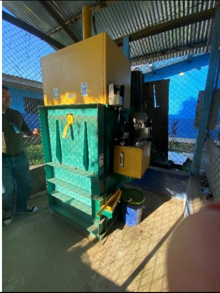
Fotografía 7. Compactadora vertical de material reciclable en el colegio Maquilam de Barrancominas-Guainía. Fuente MVCT 07-11-2024
